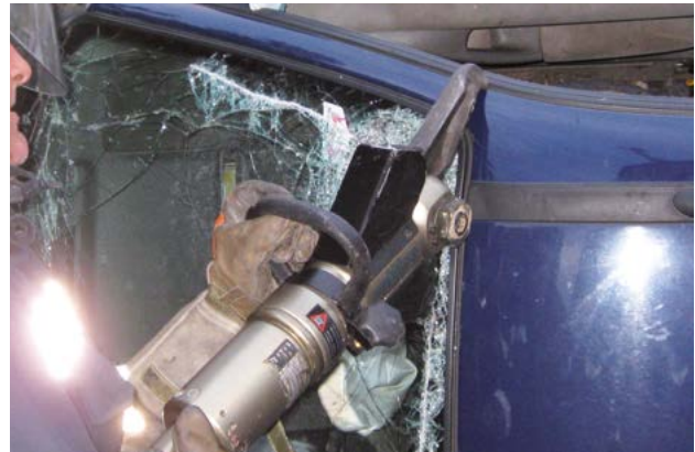
Öffnung des Daches
